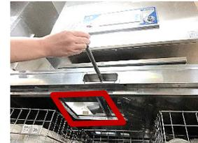
天井からつり下げられた機械を通して蒸気が入り、コンテナを消毒します。
