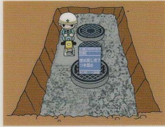
⑬ 埋め戻し完了、つき固め
