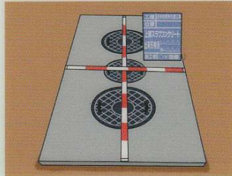
⑮ 上部スラブコンクリート 出来形検測 L=△△△△ W=△△△△
